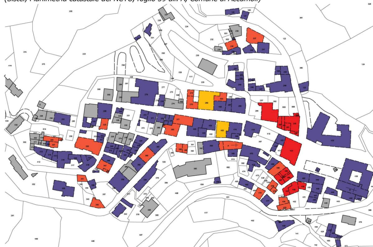
Elaborazione della planimetria d'impianto del 1939 confrontata con il catasto attuale nella situazione ante-sisma: evidenziazione dei frazionamenti, rifusioni, nuove costruzioni e demolizioni
