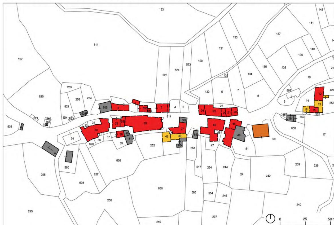
Elaborazione della planimetria catastale del N.C.E.U. attuale con evidenziazione dei crolli e delle demolizioni o inagibilità riscontrate attraverso le ordinanze sindacali post sisma
