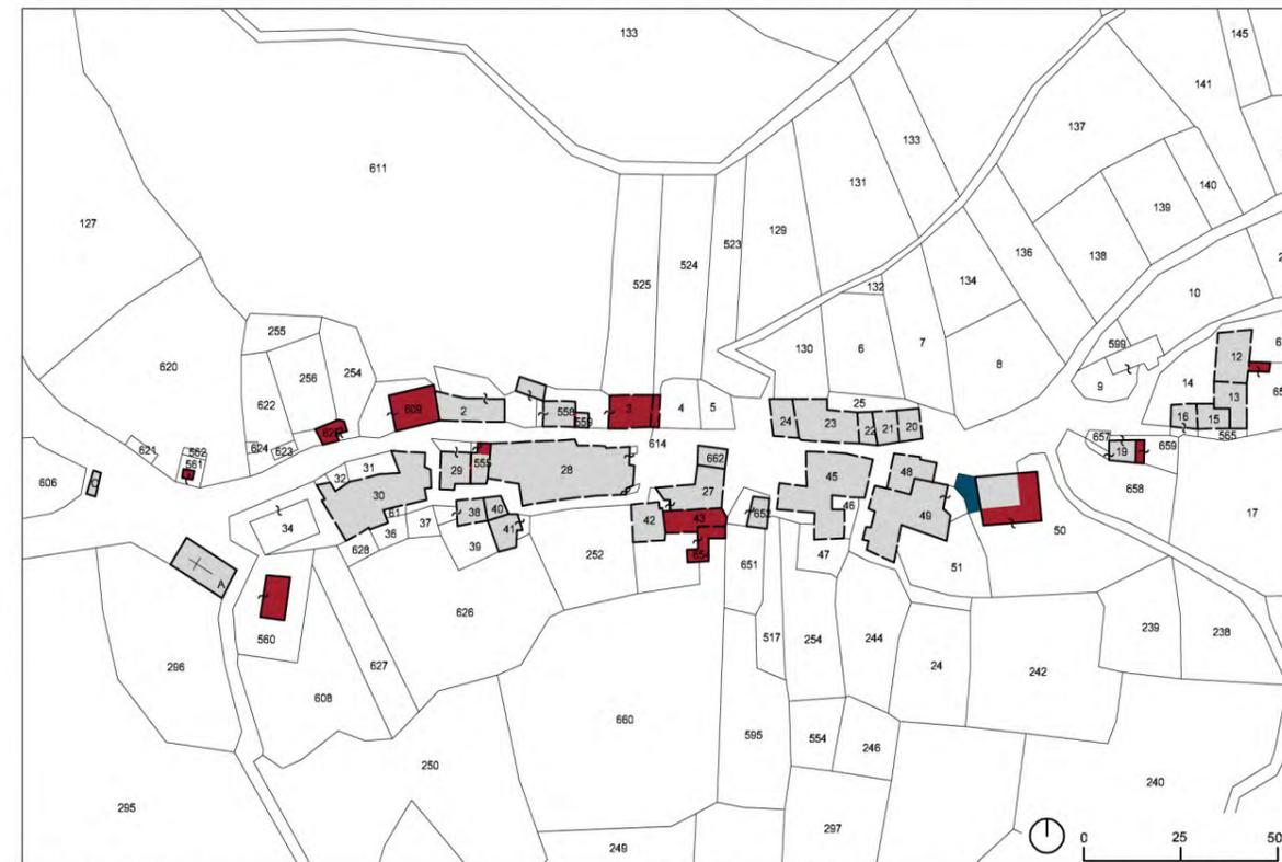
Elaborazione della planimetria d'impianto del 1940 confrontata con il catasto attuale nella situazione ante-sisma: evidenziazione dei frazionamenti, rifusioni, nuove costruzioni ed edifici non più esistenti
