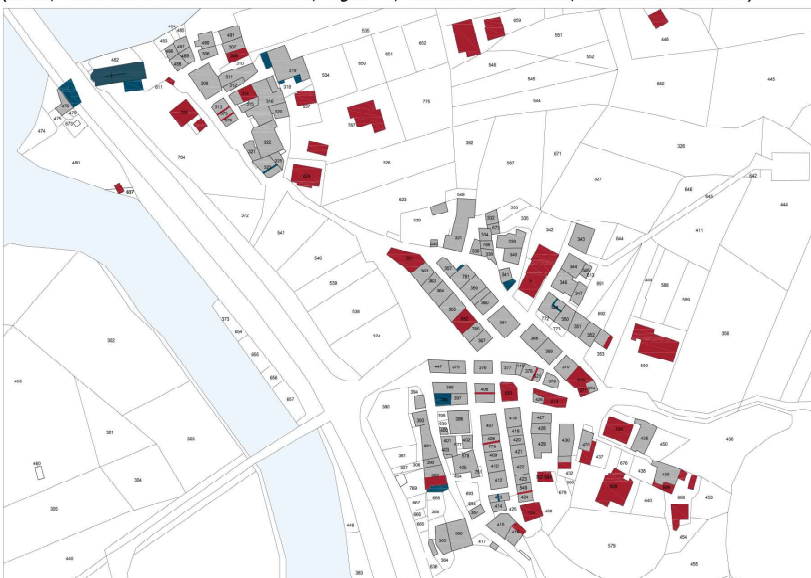
Elaborazione della planimetria d'impianto del 1939 confrontata con il catasto attuale nella situazione ante-sisma: evidenziazione dei frazionamenti, rifusioni, nuove costruzioni e demolizioni
