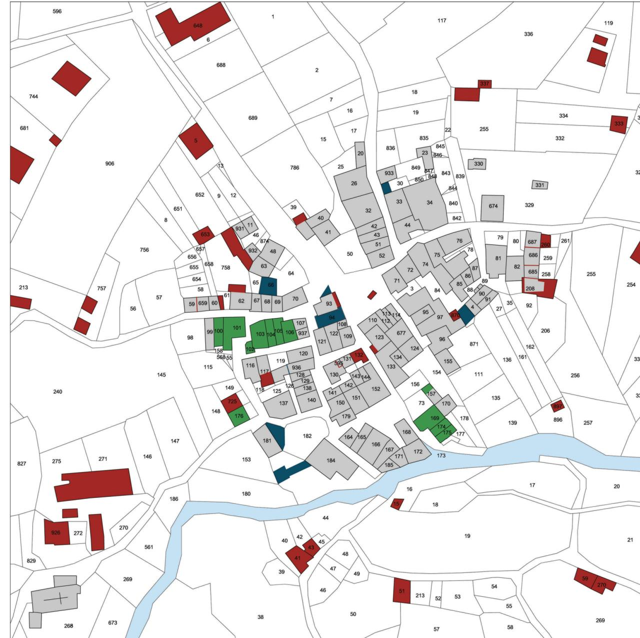
Elaborazione della planimetria d'impianto del 1940 confrontata con il catasto attuale nella situazione ante-sisma: evidenziazione di frazionamenti, rifusioni, nuove costruzioni e demolizioni
