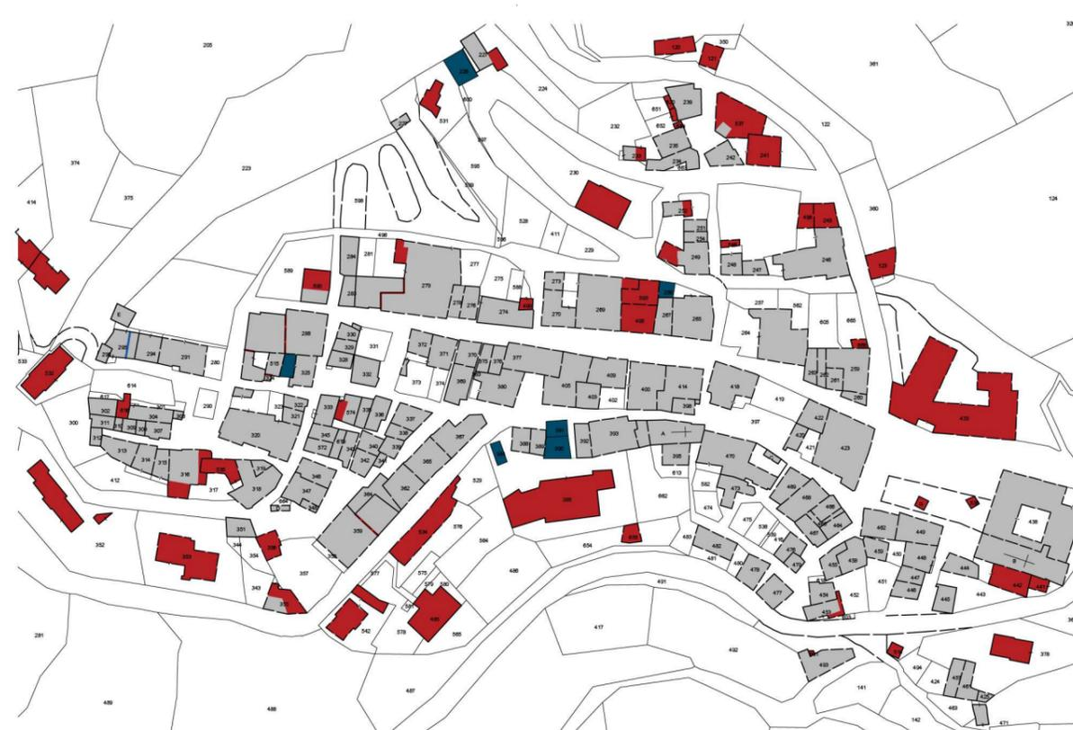
Elaborazione della planimetria d'impianto confrontata con l'abbozzo del nuovo catasto fabbricati: evidenziati frazionamenti e nuove costruzioni
