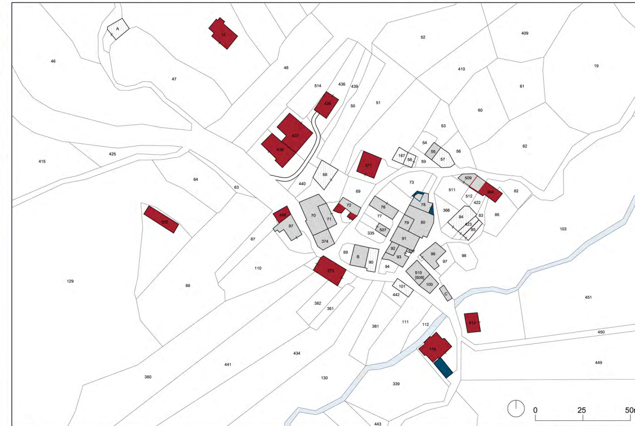
Elaborazione della planimetria del N.C.E.U. attuale confrontata con la planimetria d'impianto del 1940 nella situazione ante-sisma: evidenziazione delle nuove costruzioni, demolizioni, rifusioni e frazionamenti
