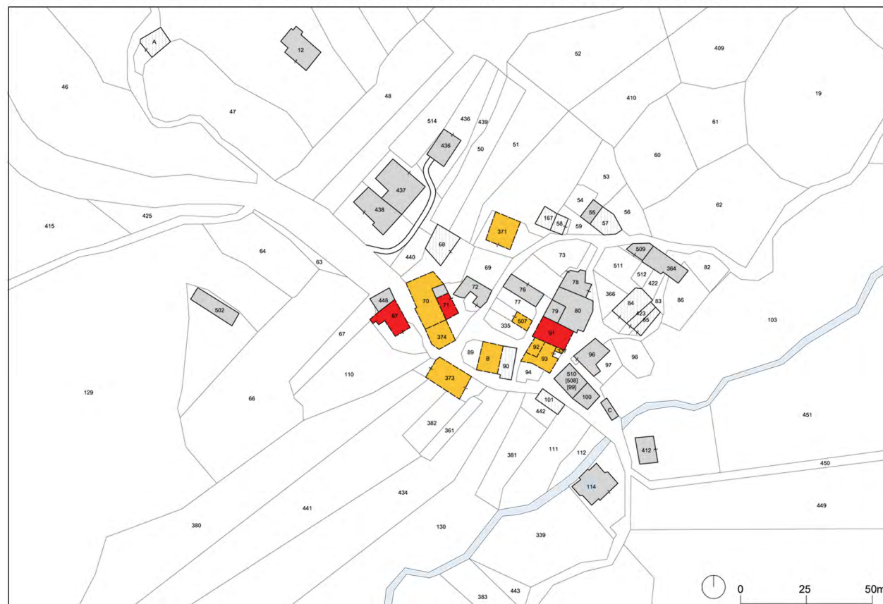
Elaborazione della planimetria del N.C.E.U. attuale con evidenziazione delle demolizioni o inagibilità o messe in sicurezza riscontrate attraverso le ordinanze sindacali post sisma
