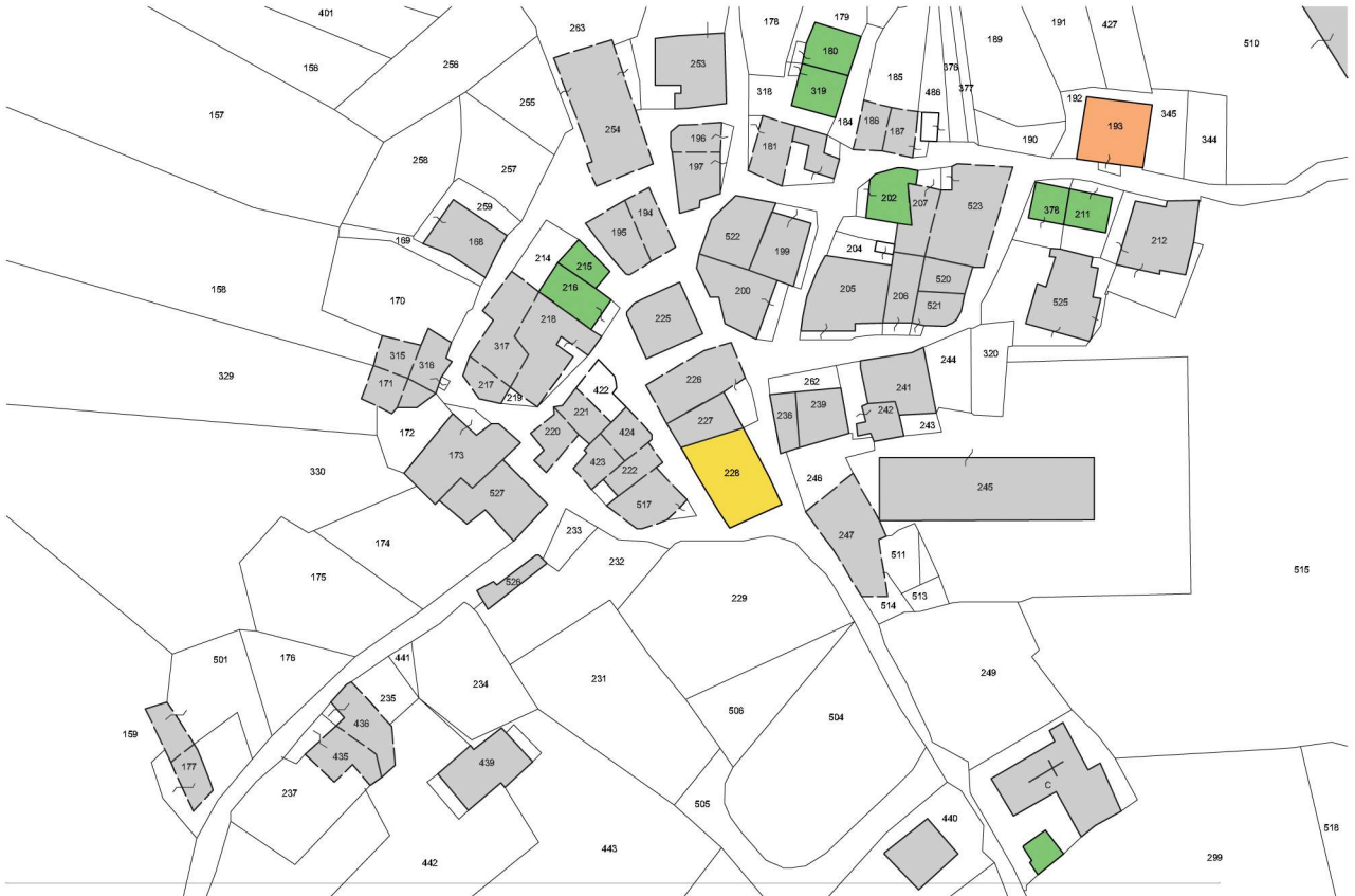
Elaborazione della planimetria catastale del N.C.E.U. attuale con evidenziazione dei crolli e delle inagibilità riscontrate attraverso le ordinanze sindacali post-sisma
